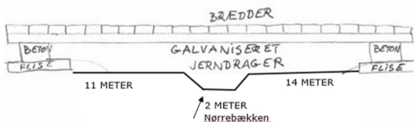
Figur 2: Principskitse af bro over Nørbæk
